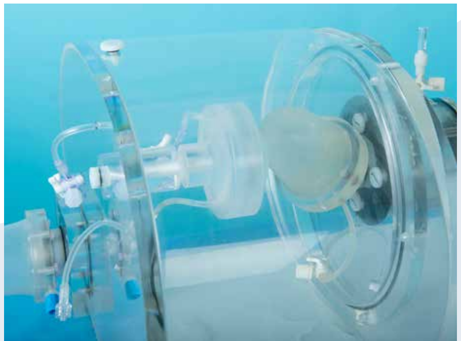
Figuur 1. AGATE fantoom uitgebreid met een fundus compartiment.
